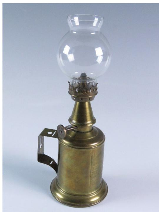
réglage de sa hauteur pouvant ainsi jouer sur l'intensité de la luminosité. Sa galerie enfilée sur le bec soutient le verre et est percée de trous créant un courant d'air permettant de tripler la puissance d'éclairage de la flamme. Sa cheminée en verre est souvent globulaire.
